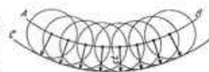
Принцип на Хюйгенс. АВ – фронт на вълната; CD – фронт на вълната след време t ( c е скоростта на светлината във вакуум) Принцип Гюйгенс. АВ – фронт на вълна; CD – фронт на вълна през интервал време t ( c – скоростта на светлината във вакуум) Huygens' principle. AB – wave front; CD – wave front after time t ( c is the velocity of light in vacuum)
